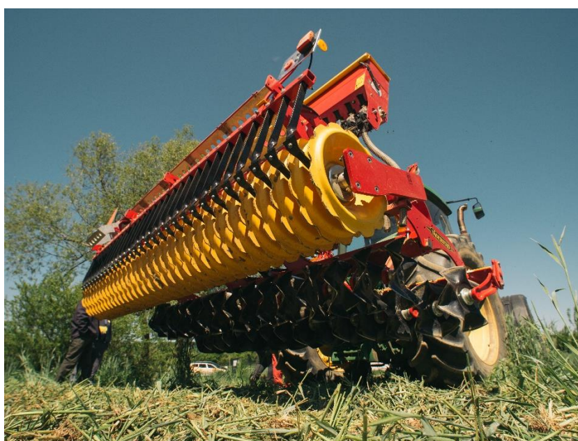
Obrázek 3 - Väderstad Carrier s vlnitými disky Cross Cutter. Foto: Martin Matěj
